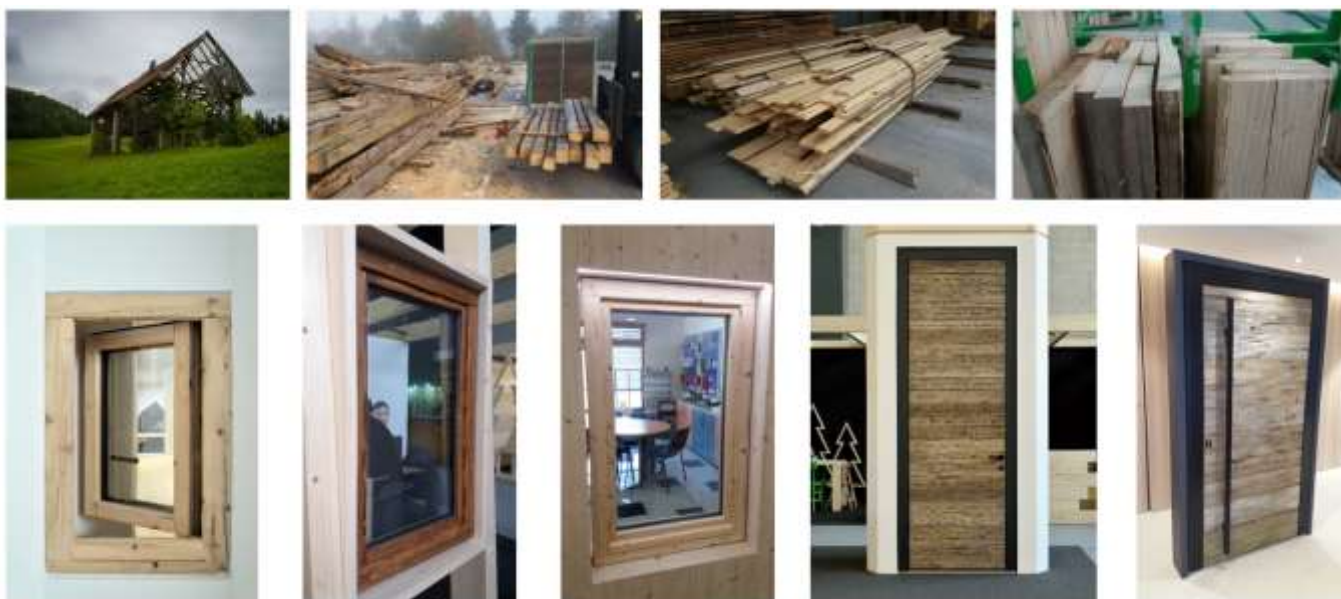
Slika 3: Proces pridobivanja odsluženega lesa in izdelki iz pridobljenega materiala
